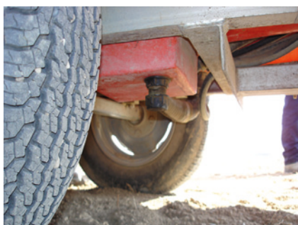
Sistema de vaciado de accionamiento difícil con imposibilidad de recoger el líquido
