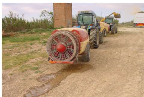
Fugas visibles e importantes en el depósito o en otras partes de la máquina
