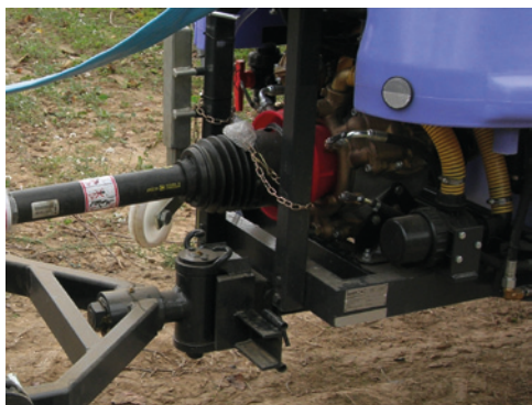
Toma de fuerza con protección y cadena de sujeción correcta
