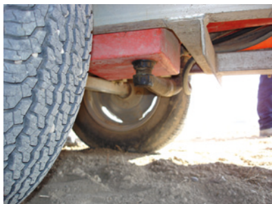
Sistema de vaciado de accionamiento difícil con riesgo de contaminación para el usuario y dificultad para la recogida del líquido
