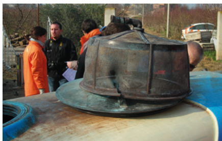
Filtro de llenado en condiciones no aceptables
