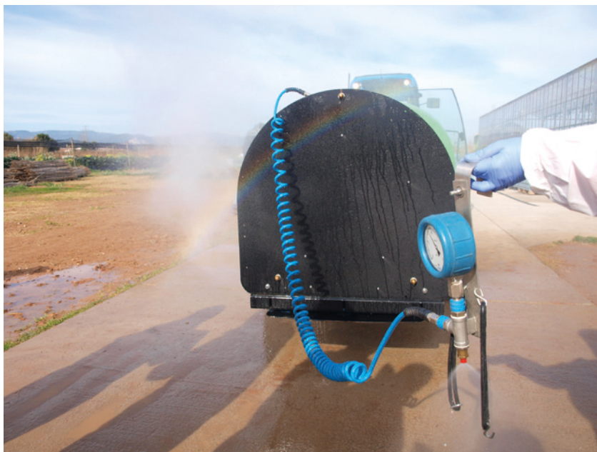
Procedimiento para comprobar la presión en las secciones
