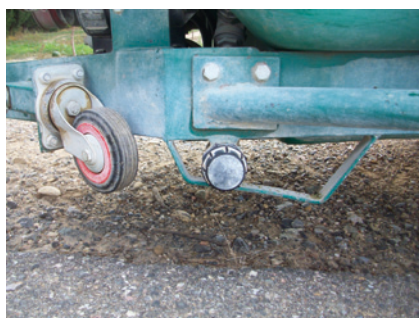
Sistema de vaciado de accionamiento difícil con imposibilidad de recoger el líquido
