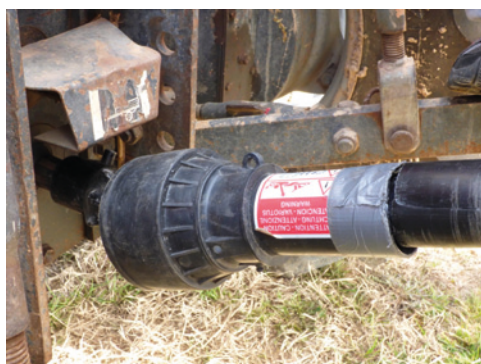
No existe la cadena de sujeción en el árbol de la máquina
