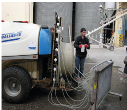
Determinación del caudal con las boquillas instaladas en el pulverizador
