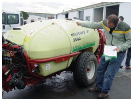
Funcionamiento correcto de la válvula de vaciado del depósito
