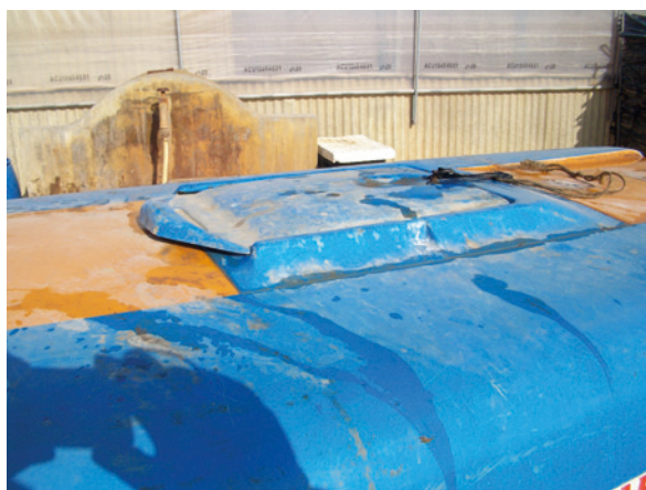
Ausencia de un sistema de compensación de presión en la tapa del depósito
