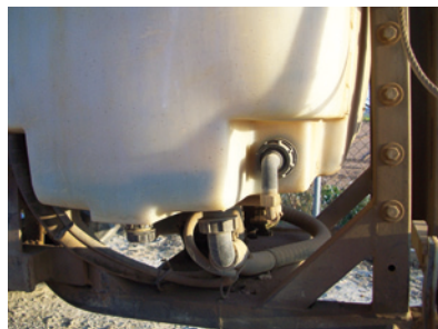
Sistema de vaciado de accionamiento difícil con riesgo de contaminación para el usuario y dificultad para la recogida del líquido
