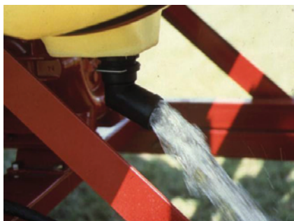
Funcionamiento correcto de la válvula de vaciado del depósito
