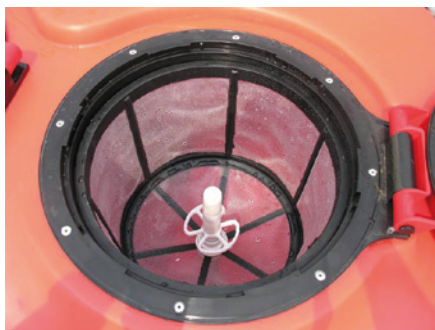
Estado correcto del filtro de llenado
