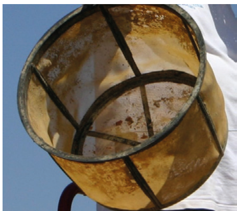
Los filtros en mal estado no realizan una función adecuada y deben sustituirse
