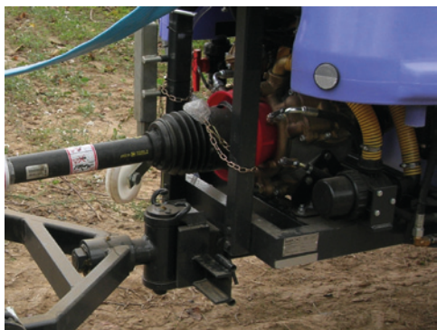
Eje de la toma de fuerza y árbol de recepción sin protección
