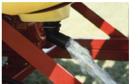
Vaciado correcto con válvula de vaciado del depósito
