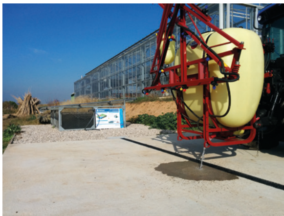
Sistema de vaciado de accionamiento difícil con riesgo de contaminación para el usuario y dificultad para la recogida del líquido
