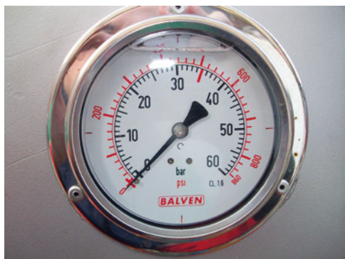
Estabilidad de la aguja indicadora de presión
