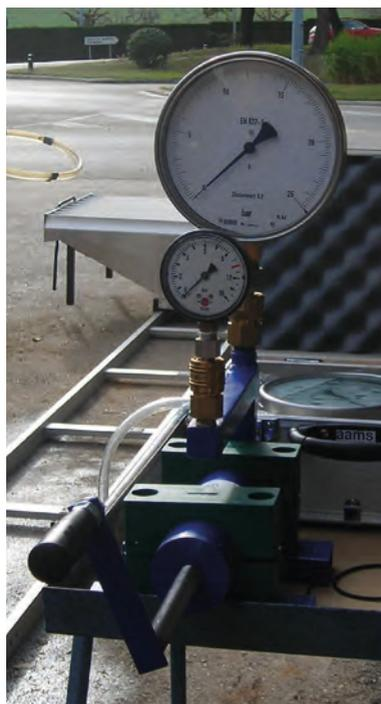
*Si es posible, desmontar el manómetro analógico del equipo y comprobar su funcionamiento en un banco de contrastación*
