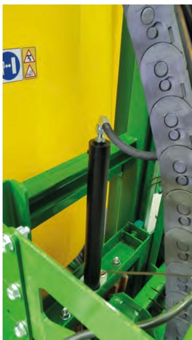
*Si el equipo dispone de dispositivo para amortiguar los movimientos involuntarios de la barra, debe funcionar correctamente*
