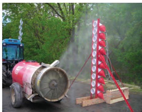
*Posteriormente, y con la máquina en marcha, se observará el circuito hidráulico y el resto de componentes de la máquina, comprobando la ausencia de fugas cuando el circuito de pulverización está funcionando.*
