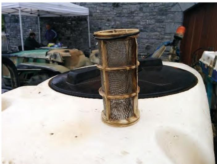
*Filtro defectuoso. El inspector debe comprobar la existencia y estado de los filtros del equipo*
