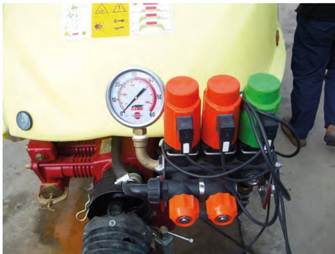
*Si el equipo dispone de retornos calibrados el inspector comprobará su funcionamiento cerrando todos los sectores de la máquina progresivamente y comprobando el mantenimiento de la presión*
