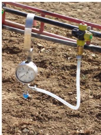
*La escala del manómetro debe ser adecuada para el rango de presiones habitual del equipo*
