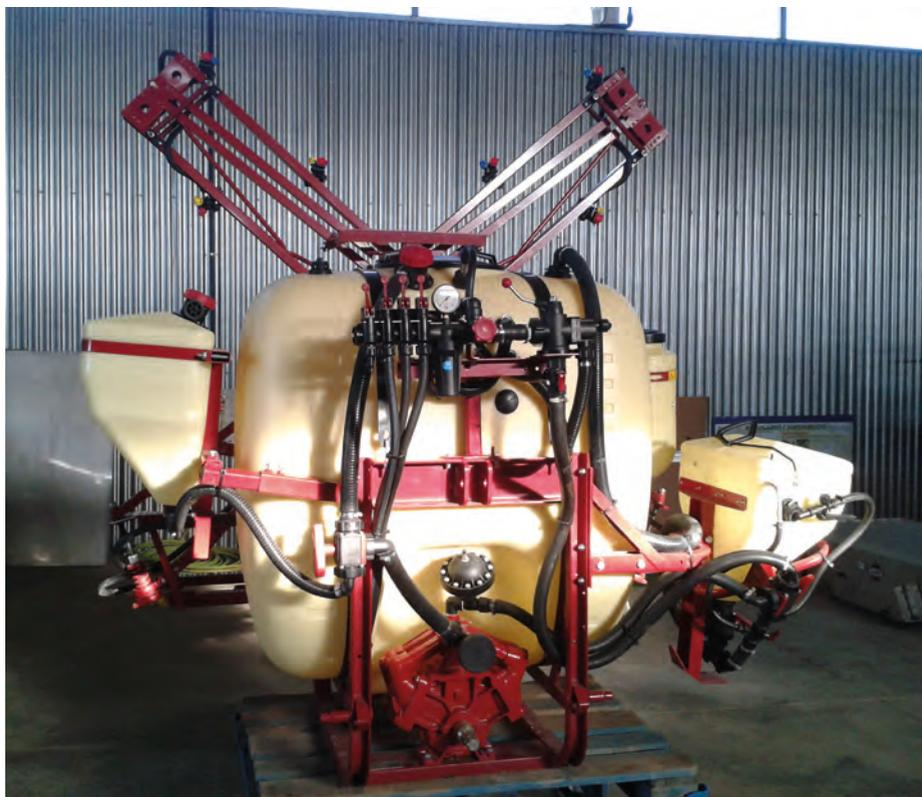
*Si la cámara de aire no funciona correctamente la aguja del manómetro puede presentar oscilaciones que dificulten la lectura de la presión*
