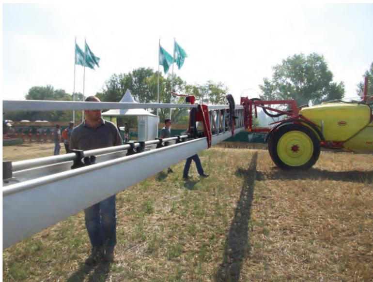
*Comprobar los dispositivos de amortiguación de la barra, simulando un cambio en inclinación de la barra y observando su retorno a la posición inicial*
