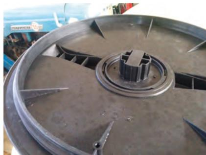
*Sistema de compensación de presión en buen estado
