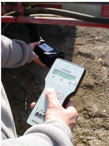
*Medición del caudal de las boquillas en una barra con un caudalímetro electrónico. El valor medido se debe comparar con el caudal nominal de las boquillas suministrado por el fabricante*
