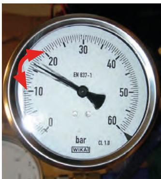
*La oscilación de la aguja del manómetro no permite la lectura adecuada de la presión de trabajo. Esto puede deberse a un fallo en el manómetro o a un mal funcionamiento del calderín. En este caso se debe comprobar que la presión del calderín es la correcta*
