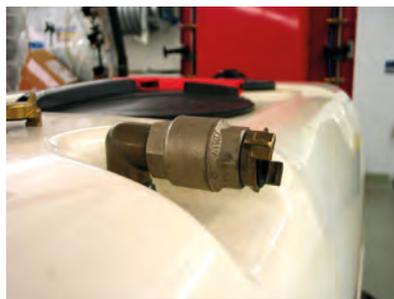
*Existe un sistema anti retorno en el dispositivo de carga del depósito.
