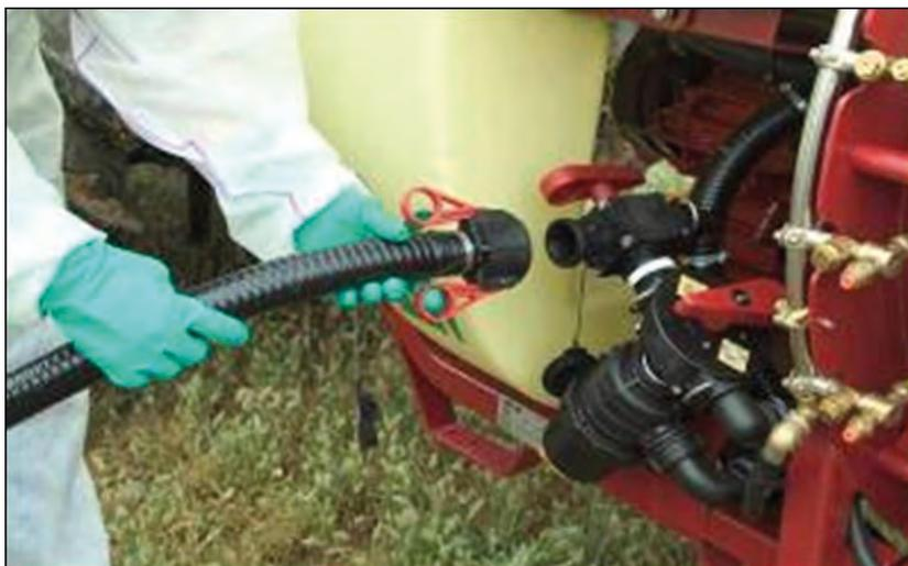
*Ajuste y comprobación del sistema de llenado del pulverizador*
