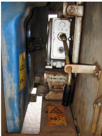
*Se debe comprobar el funcionamiento del dispositivo que permite la desconexión del ventilador*
