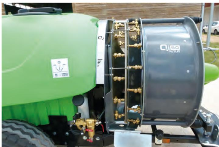
*En los equipos provistos con dispositivos específicos para el ajuste de las características del caudal de aire del ventilador, como el de la imagen, el inspector comprobará el correcto funcionamiento del dispositivo de ajuste*
