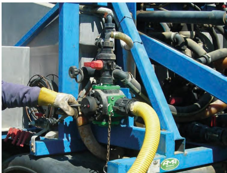
*El sistema anti retorno del dispositivo de llenado del depósito
