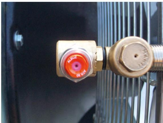
*El sistema permite la orientación de las boquillas correctamente y asegurar al mismo tiempo la posición adecuada para su buen funcionamiento*
