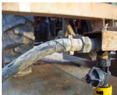
*Es preciso comprobar el estado de las tuberías para detectar posibles fugas*
