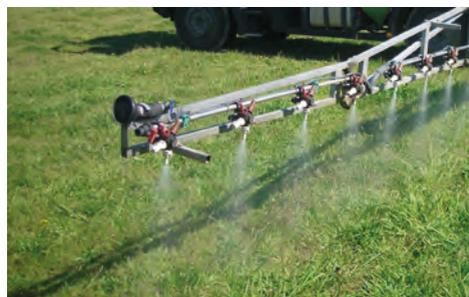
*Al régimen de trabajo nominal con el máximo caudal y a la máxima presión de trabajo debe observarse una pulverización adecuada y una buena agitación en el depósito*
