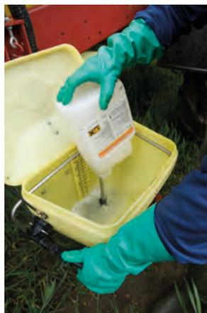
*El sistema de limpieza de envases, si está presente en el equipo, debe funcionar correctamente.*
