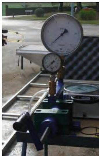
*Si es posible, desmontar el manómetro analógico del equipo y comprobar su funcionamiento en un banco de contrastación*
