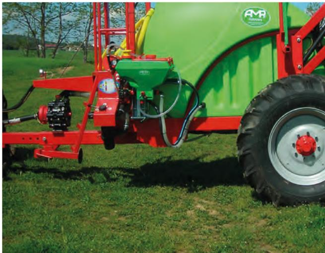
*El inspector debe comprobar el estado del bastidor y la estructura de la máquina, especialmente en aquellos puntos que presenten riesgo de rotura*
