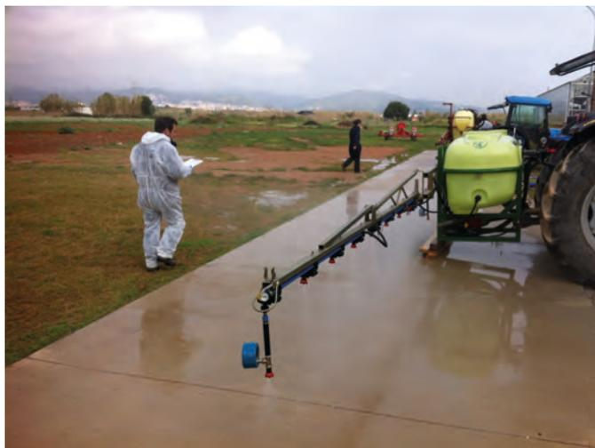
*Se comprobará la caída de presión instalando manómetros calibrados en todas las secciones de la barra y comprobando las variaciones de presión*
