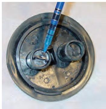
*Sistema de compensación de presión en buen estado
