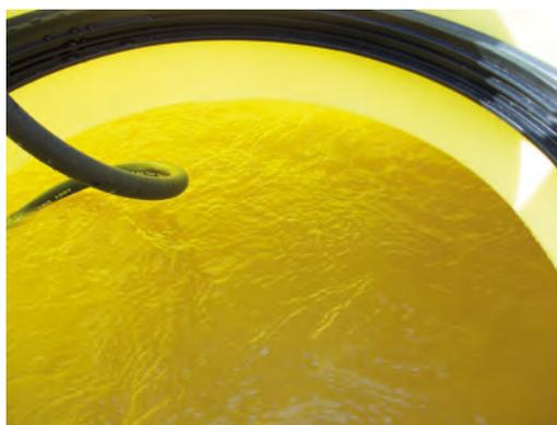
*Se observa una agitación correcta y uniforme en todo el depósito, lleno hasta la mitad de su capacidad nominal, con la bomba funcionando al régimen nominal de la TDF*
