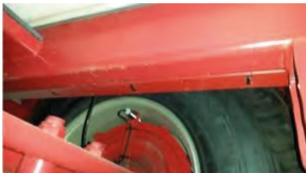
*El caudalímetro (izquierda) y el sensor de velocidad (derecha) presentes en el equipo deben funcionar correctamente, por lo que se debe comprobar su funcionamiento de acuerdo con lo establecido en la norma de inspecciones*
