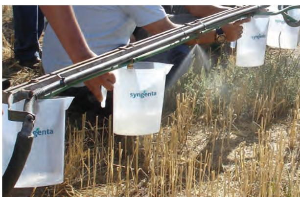
*Para la determinación del caudal de las boquillas es preciso utilizar equipos que cumplan con las especificaciones requeridas en la norma de inspección, como una probeta certificada. Las jarras de calibración no son adecuadas*
