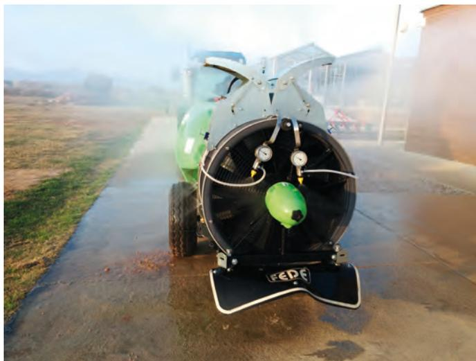
*En el caso del método cualitativo se colocará un manómetro calibrado en cada lado del equipo y comprobará el mantenimiento de la presión con el equipo en marcha y las boquillas de máximo caudal abiertas*
