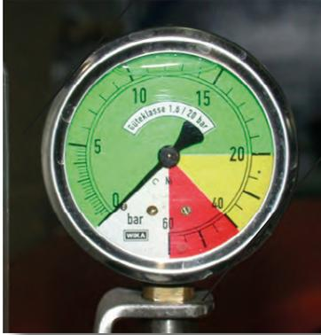
*El diámetro mínimo de la esfera de un manómetro analógico debe ser al menos de 63 mm*
