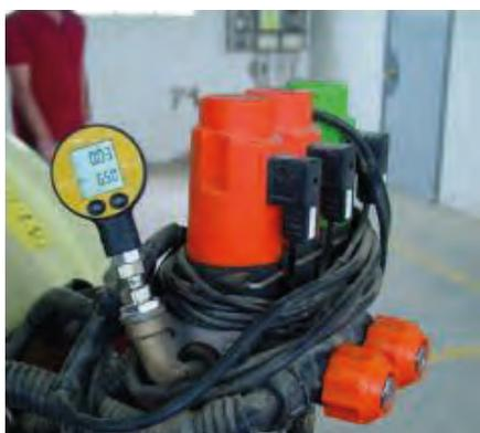
*Si el manómetro del equipo no puede desmontarse y/o se trata de un manómetro electrónico, la contrastación se puede realizar instalando un manómetro calibrado en la máquina y realizar las lecturas de acuerdo con lo establecido en la norma*
