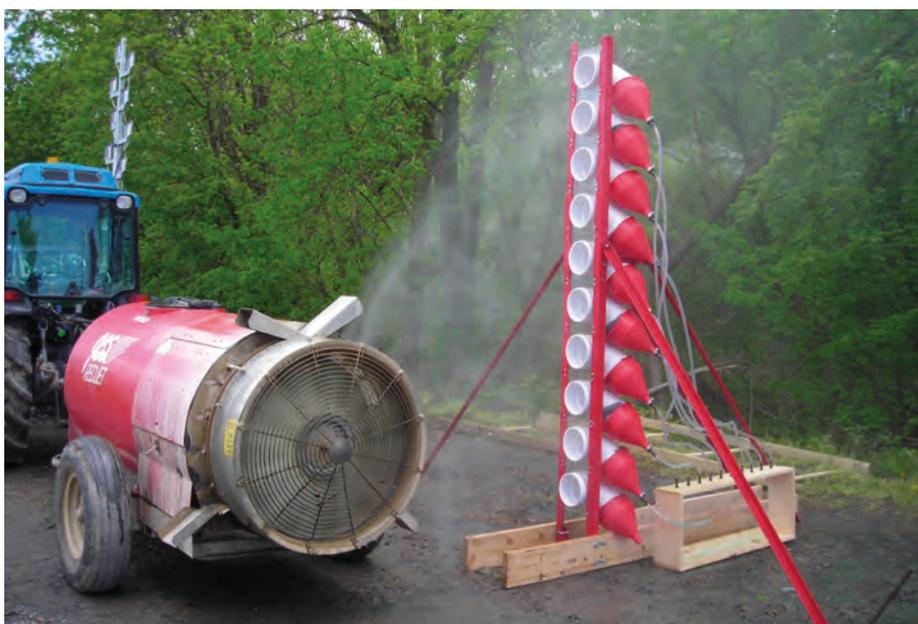
*La determinación de la distribución vertical de la pulverización si se dispone del banco de medición vertical correspondiente es útil para comprobar la influencia de la orientación de las boquillas en la distribución. No es una comprobación obligatoria en el proceso de la inspección.*
