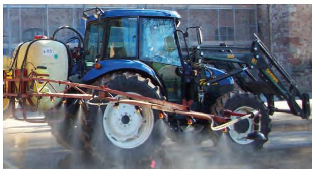
*La ausencia de elementos protectores de boquillas extremas o de protectores inadecuados incrementa el riesgo de roturas*
