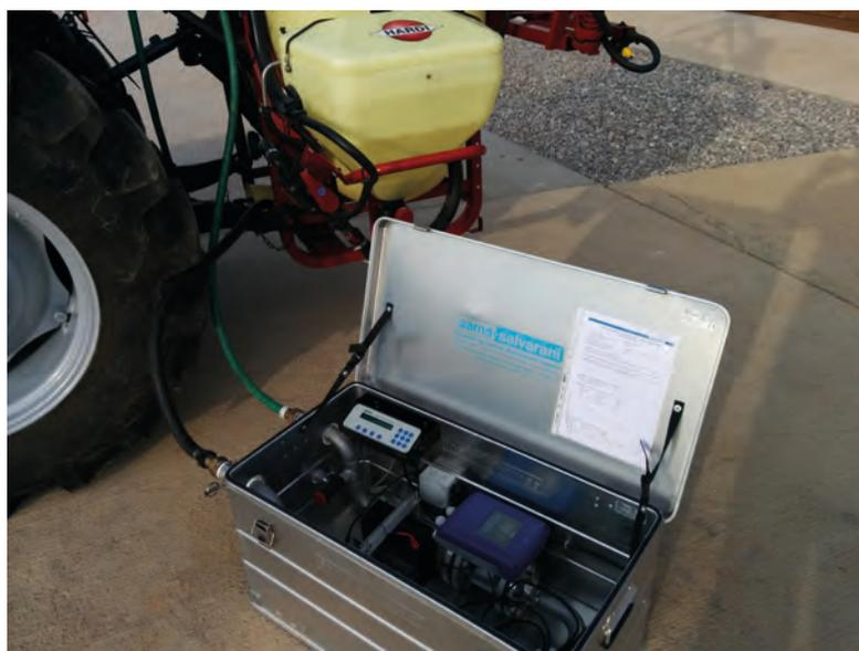
*Caudalímetros específicos para la medida del caudal total de la bomba*
