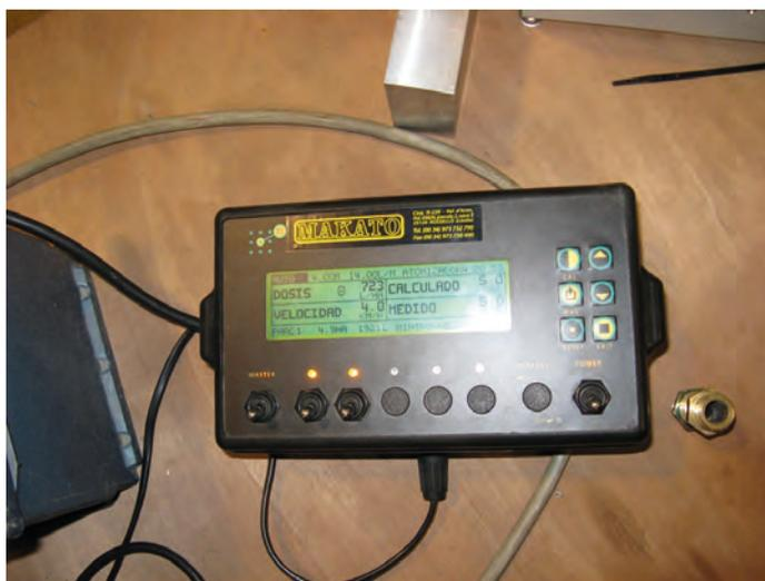
*Si el equipo está provisto de ordenador o consola con información de los parámetros de la aplicación, el inspector procederá a realizar lo explicado en la norma de inspecciones para comprobar que la información suministrada por el dispositivo es correcta*
