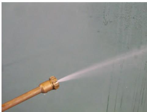
*Comprobación de la regulación del ángulo de pulverización*
