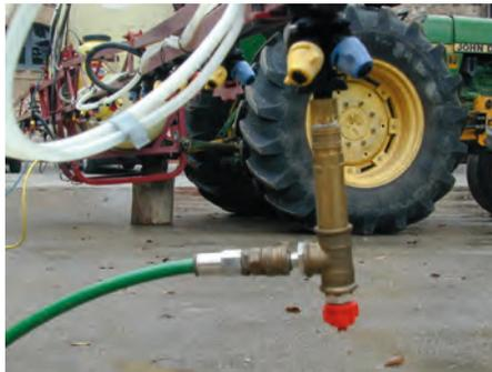
*La colocación de un manómetro certificado conectado al inicio de cada sección de la barra nos permite comprobar si la variación de presión al cerrar y abrir sectores supera el límite del 10% tolerado*
