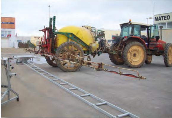
*Se determinará la distribución transversal utilizando un equipo adecuado. El coeficiente de variación obtenido tras la prueba no debe ser superior al 10%*
