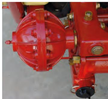
*Si el equipo dispone de un calderín (amortiguador de presión), se comprobará la presión del mismo*
