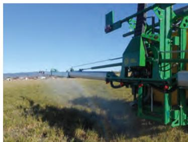
*La barra debe ser estable en todas las direcciones, sin presentar movimientos excesivos debidos al desgaste y/o a una deformación permanente.*
