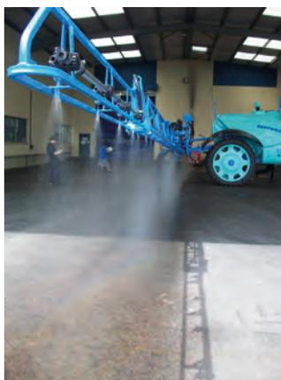
*Se debe conseguir la verticalidad del cuerpo de las boquillas con una desviación máxima de 10°*
