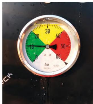
*La escala del manómetro debe ser adecuada para el rango de presiones aconsejadas por el fabricante*
