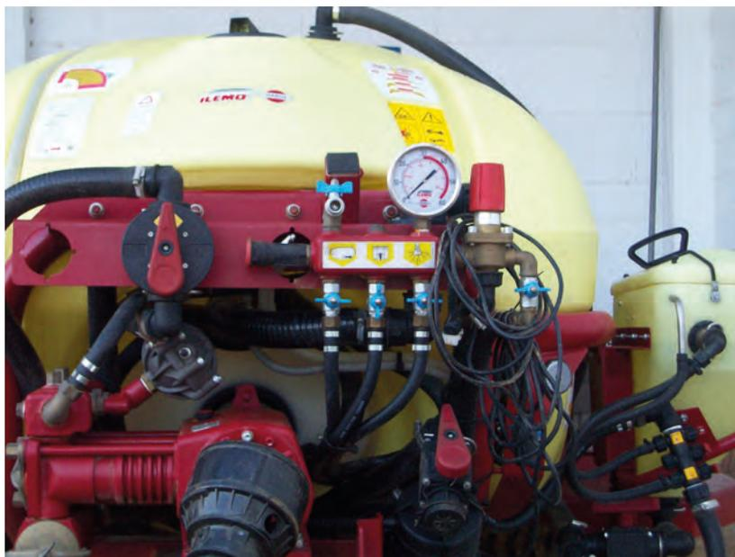
*Si la cámara de aire no funciona correctamente la aguja del manómetro puede presentar oscilaciones que dificulten la lectura de la presión*
