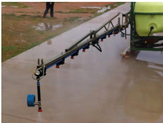
*Para la comprobación visual de la capacidad de la bomba se colocará un manómetro calibrado en las boquillas de los extremos de la barra y se comprobará el mantenimiento de la presión a la vez que se observa el funcionamiento del sistema de agitación hidráulico*
