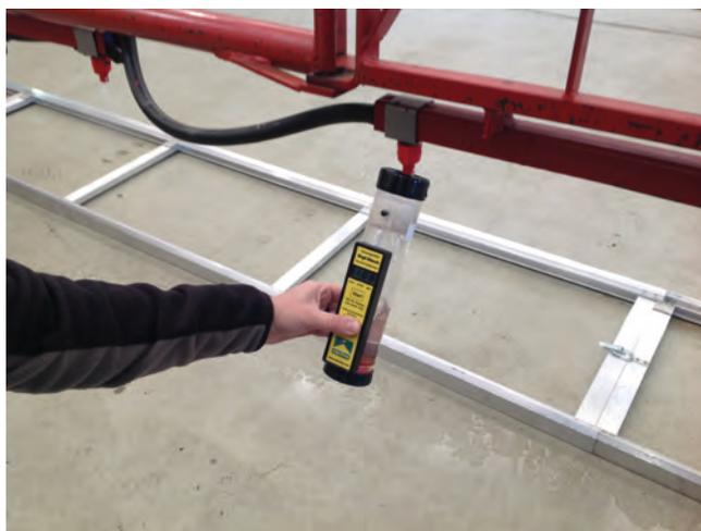
*Medida del caudal con las boquillas colocadas en la barra*
