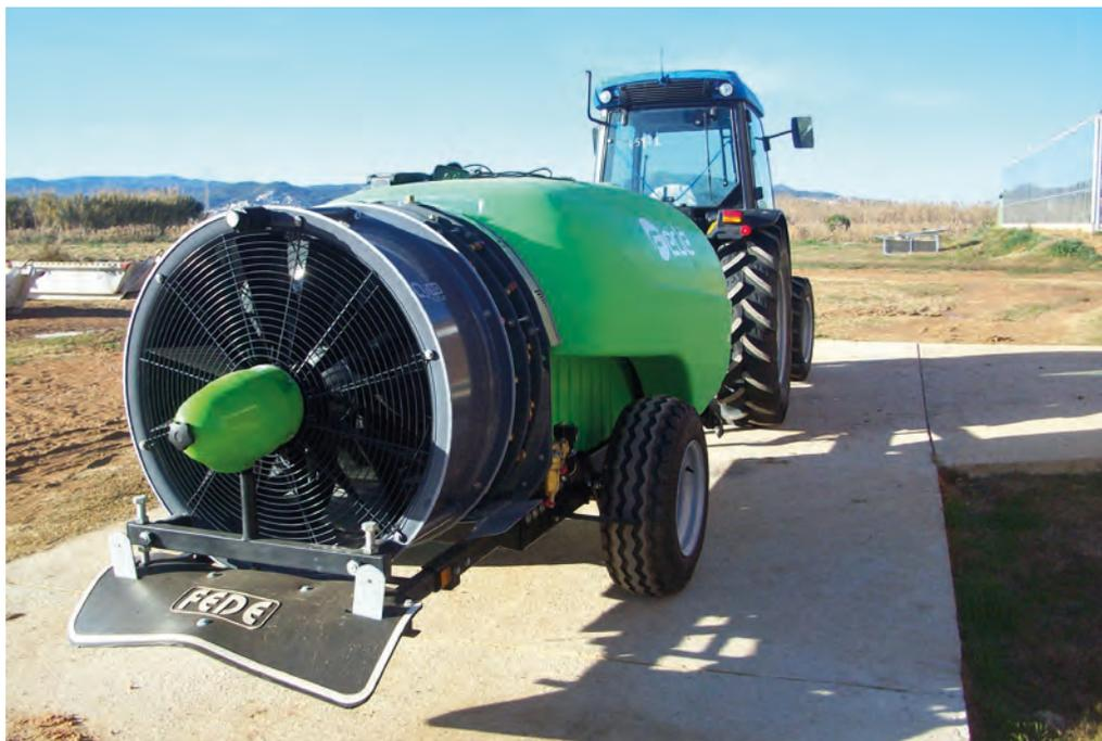
*El inspector comprobará primero, con el equipo en funcionamiento, pero con las boquillas cerradas, que no se producen fugas. El inspector comprobará primero, con el equipo en funcionamiento pero con las boquillas cerradas, que no se producen fugas.*
