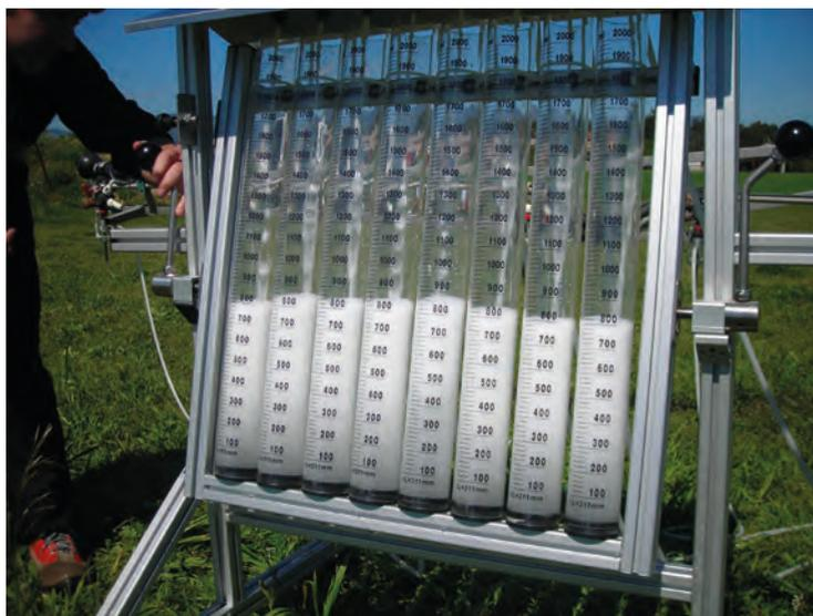
*Se debe comprobar el caudal unitario de cada una de las boquillas de la barra para compararlo posteriormente con el caudal nominal indicado por el fabricante. En el caso de no conocer el caudal nominal de las boquillas se compararán los valores obtenidos con el caudal medio de todas las boquillas de la barra*
