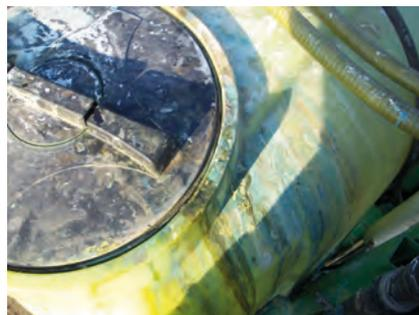
*Se deben evitar fugas de líquido por el mal estado o el cierre defectuoso de la tapa*
