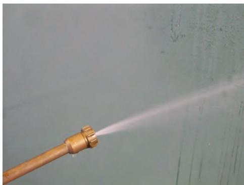
*Comprobación de la regulación del ángulo de pulverización*
