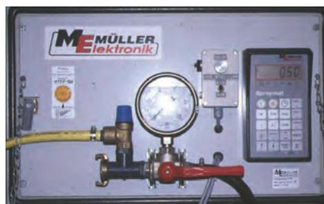
*Caudalímetros específicos para la comprobación del caudal nominal de la bomba*
