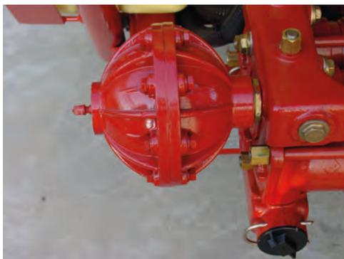
*Si el equipo dispone de un calderín (amortiguador de presión), se comprobará la presión del mismo*
