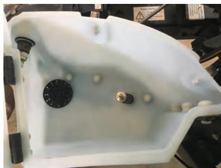
*Debe existir una rejilla que impida la entrada de objetos de un diámetro mayor a 20 mm*
