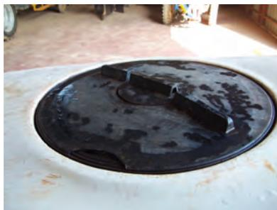
*Una tapa en mal estado o mal diseñada puede provocar fugas de caldo*
