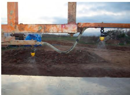
*Las variaciones excesivas en la altura de la barra impiden una distribución uniforme en el campo*
