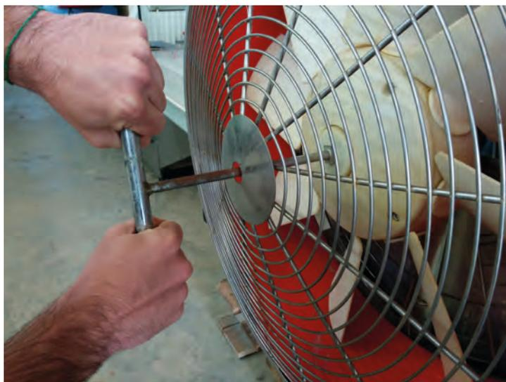
*Se comprueba el funcionamiento del dispositivo que permite el ajuste y orientación de los álabes del ventilador*
