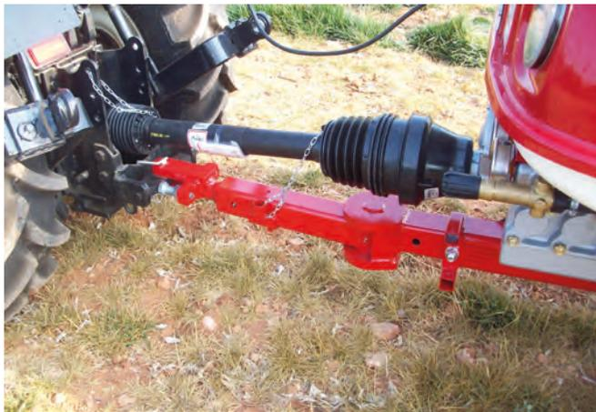
*Algunos equipos disponen de embrague en la transmisión del movimiento. Este previene de arranques y paros bruscos. El inspector debe comprobar su estado y funcionamiento, en caso de que esté presente.*
