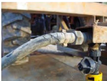
*Las conducciones no deben presentar dobleces excesivas ni corrosión o abrasión*
