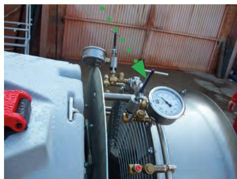
*La caída de presión entre el punto donde se mide en el pulverizador y en la boquilla más alejada del punto de alimentación de cada uno de los lados de la máquina no debe superar el 15%*
