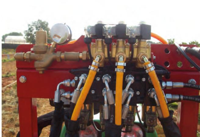
*Las conducciones del sistema hidráulico de accionamiento de los elementos del pulverizador, si dispone de ellos, deben estar en buen estado, sin presentar desgastes y/o roturas que puedan provocar accidentes o contaminación*
