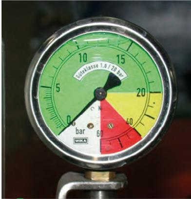
*Analizar la variación de presión entre los manómetros calibrados colocados en la entrada y el extremo de cada uno de los sectores de la barra*
