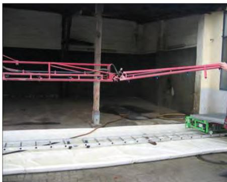
*En el caso de existir elementos que permitan la recuperación automática de la posición de la barra, éstos deben funcionar correctamente*
