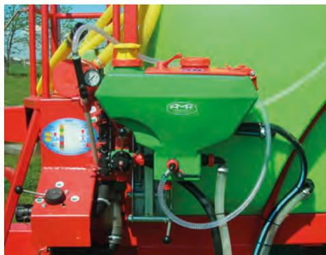
*Si el equipo dispone de incorporador de producto, éste debe presentar un buen estado y funcionar correctamente*
