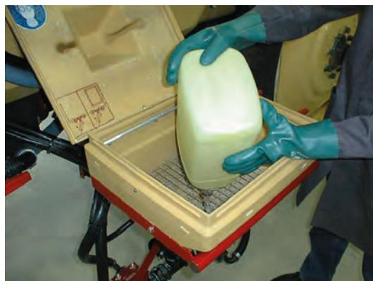
*Comprobar con un recipiente vacío el buen funcionamiento del sistema de limpieza de envases.*
