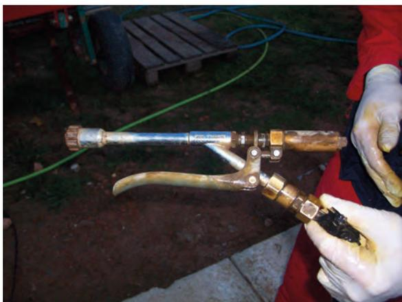
*Comprobar la ausencia de goteo en la posición "off"*
