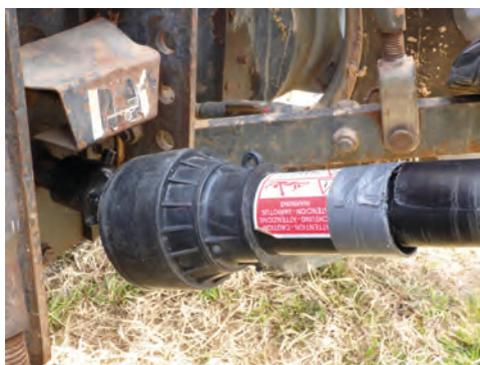
*No existe la cadena de sujeción en el árbol de la máquina*
