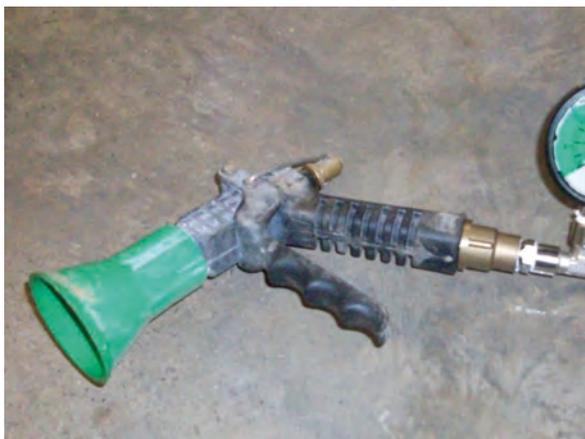
*El gatillo de la pistola debe funcionar correctamente. Se debe comprobar el dispositivo de bloqueo cuando está cerrado y la imposibilidad de bloquearlo en posición abierta*
