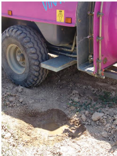
*La boquilla sigue goteando tras el cierre de la válvula principal*
