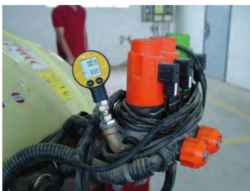
*Si el manómetro del equipo no puede desmontarse y/o se trata de un manómetro electrónico, la contrastación se puede realizar instalando un manómetro calibrado en la máquina y realizar las lecturas de acuerdo con lo establecido en la norma*
